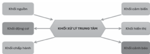
Hình 1. Sơ đồ khối nguyên lý hoạt động của robot
