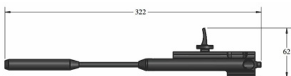
Hình 3. Cơ cấu tạo lực giạt điện từ cho súng STV 380
