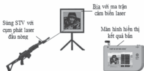
Hình 1. Mô hình thiết bị bắn tập cho dòng súng tiểu liên STV
