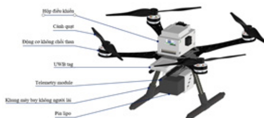
Hình 1. Cấu tạo hệ thống máy bay không người lái sử dụng UWB
