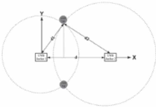
Hình 2. Sơ đồ bố trí vị trí của các UWB anchor và UWB tag
