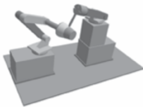
Hình 5. Mô phỏng robot tác hợp gia công tiện tinh bề mặt chi tiết hình côn;
