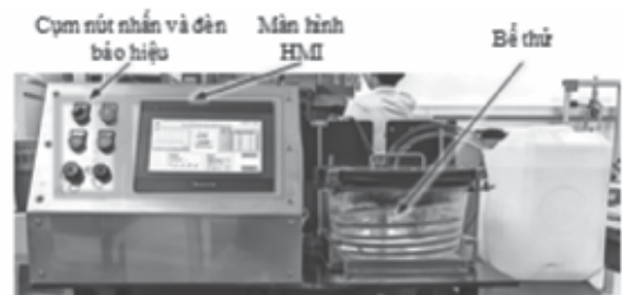
Hình 5. Hệ thống kiểm nghiệm độ ăn mòn \text{SO}_2 cho sprinkler theo TCVN 6305-1:2007
