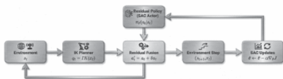
Hình 4. Cấu trúc tổng thể bộ điều khiển cánh tay robot đánh trúng bóng dựa trên phương pháp học tăng cường mềm Actor-Critic
