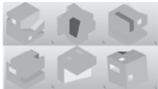
Hình 1. Ví dụ các mô hình CAD trong bộ dữ liệu MFCAD với nhãn ngữ nghĩa ở mức mặt, được sử dụng làm cơ sở xây dựng biểu diễn đồ thị.
