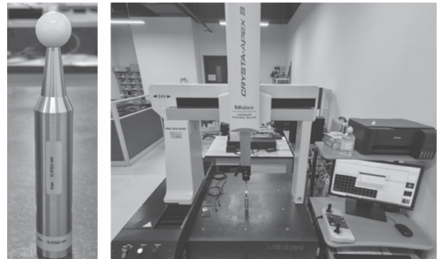
Hình 1. Quả cầu đã hiệu chuẩn được đo trên máy đo tọa độ Mitutoyo Crysta Apex S544.
