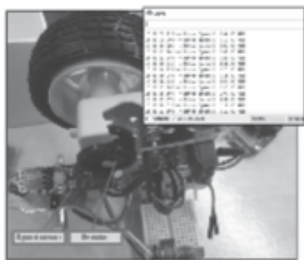
Hình 6. Kiểm tra Module điều khiển động cơ L9110S.
