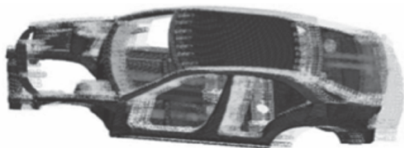
Hình 1. Mô hình phần tử hữu hạn khung vỏ ô tô sau khi tạo liên kết [9]
