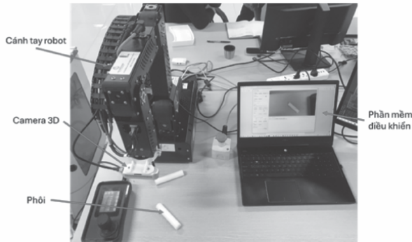
Hình 1. Hệ thống thị giác robot cấp phôi tự động cho máy tiện CNC.
