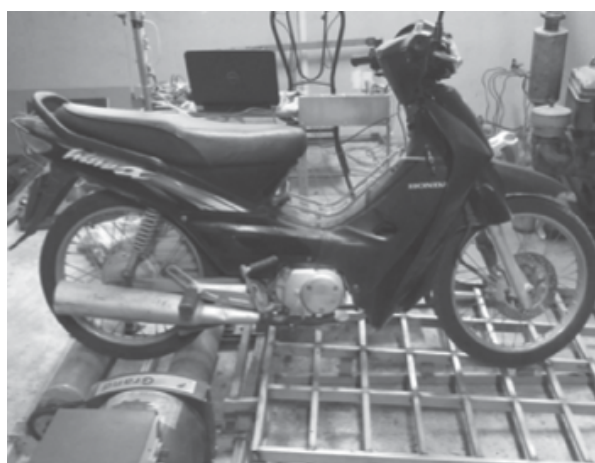
Hình 1. Xe máy Wave Alpha trên băng thử nghiệm
