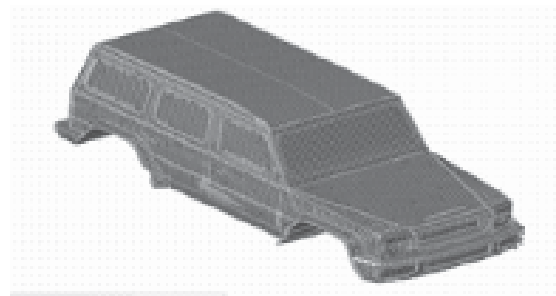
Hình 1. Mô hình phần xe SUV Mercedes G63 đã chia lưới thân vỏ
