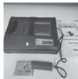
Hình 3. Thiết bị đo các chỉ tiêu bề mặt:
