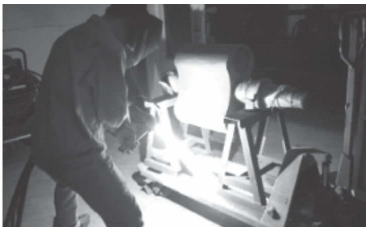
Hình 4. Quá trình phun phủ Al_2O_3-40TiO_2 lên roto cánh quạt Roots
