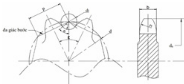
Hình 3. Sơ đồ tính đĩa xích
