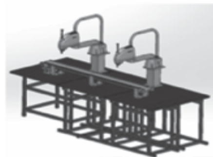
Hình 2. Mô hình cell thực nghiệm gồm hai robot SCARA KUKA KR 6 R700 Z200, PLC SIMATIC S7-1200 và mạng truyền thông PROFINET RT.
