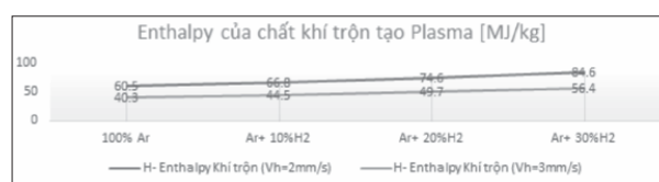
Hình 2. H- Enthalpy của chất khí trộn Ar + H 2 tạo Plasma [MJ/kg] ứng với tốc độ hàn 2mm/s và 3mm/s.
