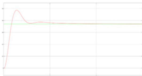
Hình 7. Đáp ứng PID của chân kích số 2
