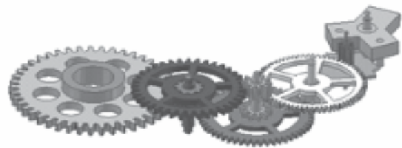
Hình 2.5. Cụm bánh răng NM MVTr-62 khi xây dựng 3D để kiểm tra vướng kẹt
