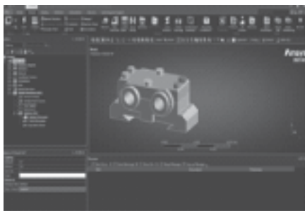
Hình 1. Mô hình 3D của cụm gối đỡ trục chính
