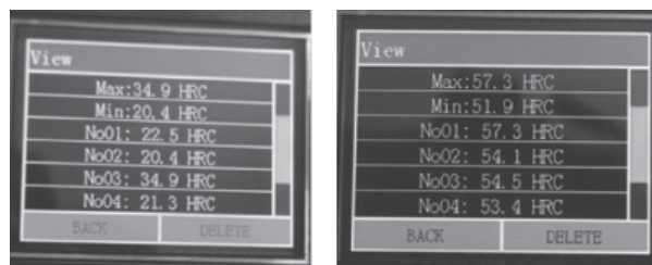
Hình 2. Kết quả đo độ cứng sau ram và tôi
