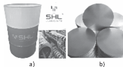
Hình 2.1. a) Dầu dập vuốt ; b) Phôi 3 lớp
