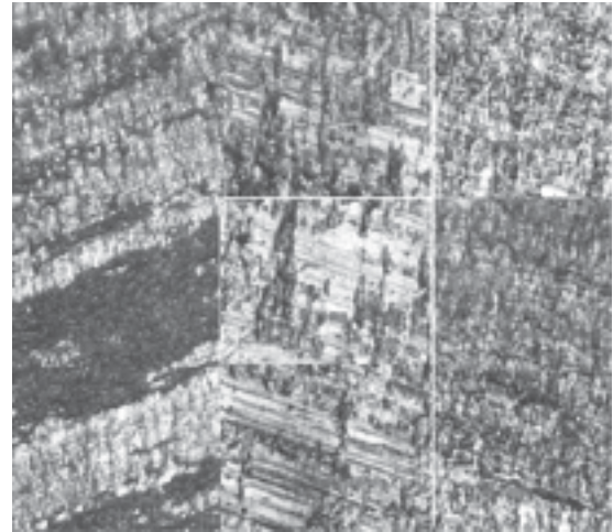
Hình 3.3. Hình ảnh hiển vi bề mặt phôi SUS 430 sau đập ở độ phóng đại 50X
