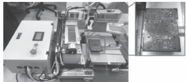
Hình 6. Mô hình chế tạo và thử nghiệm điều khiển vị trí thực hiện yêu cầu điều khiển nội suy mặt phẳng
