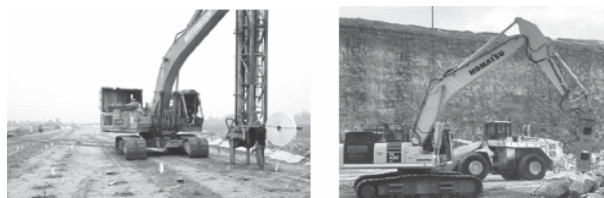
a) b) Hình 1. Bộ công tác lắp trên máy đào: a) Bộ cắm bậc thềm; b) Búa thủy lực
