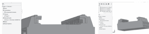
Hình 7. Quá trình đặt lực tác dụng vào chân ép cọc khi ép cọc
