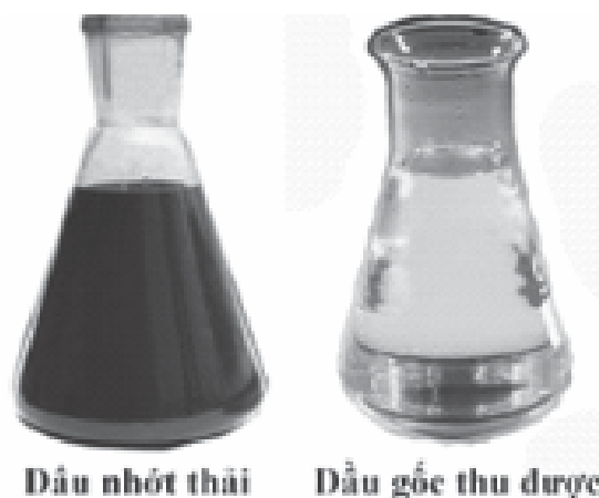
Hình 4. Kết quả tái chế dầu nhớt thải
