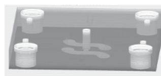
Hình 3. Lòng khuôn sau khi được cắt lớp
