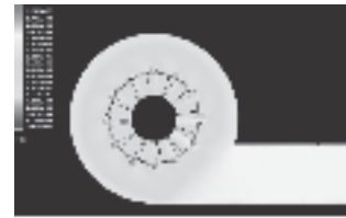
Hình 4. Đường phân bố áp suất trong Turbine.
