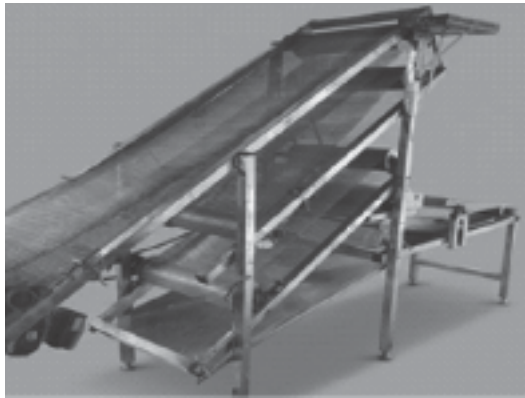
Hình 8. Hệ thống băng tải lưới kết hợp sấy làm nguội thực tế đã chế tạo.
