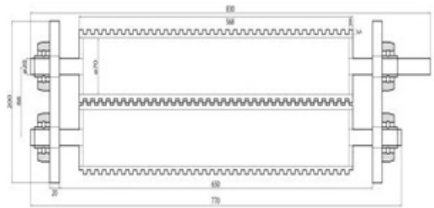
Hình 10. Cụm dao cắt sợi mì Quảng dạng tấm thành dạng sợi
