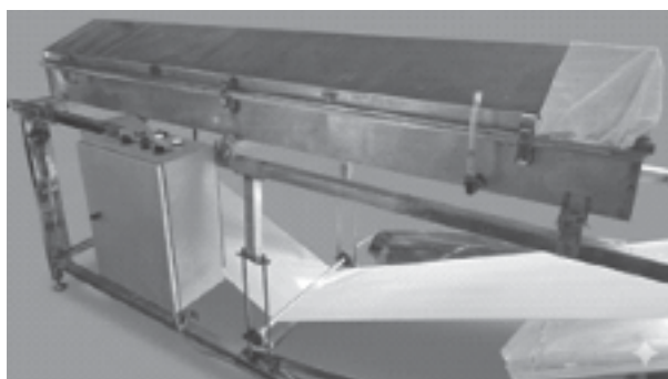
Hình 7. Buồng hấp lớp thứ hai thực tế đã chế tạo.
