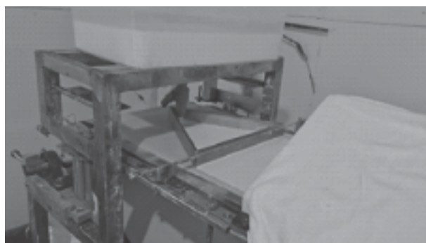
Hình 4. Cụm tráng lớp bột thứ nhất đã chế tạo
