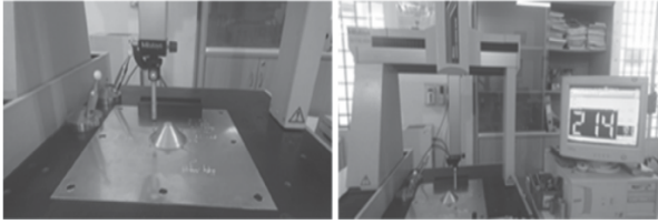
Hình 4. Đo tọa độ chi tiết bằng máy đo tọa độ
