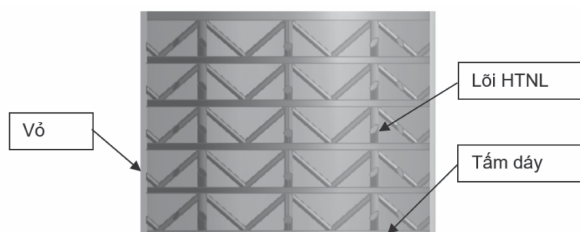
Hình 4. Mô hình bộ hấp thụ năng lượng đa tầng
