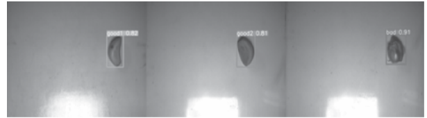
Hình 6. Kết quả kiểm tra mô hình phân loại với tòi di chuyển trên băng tải
