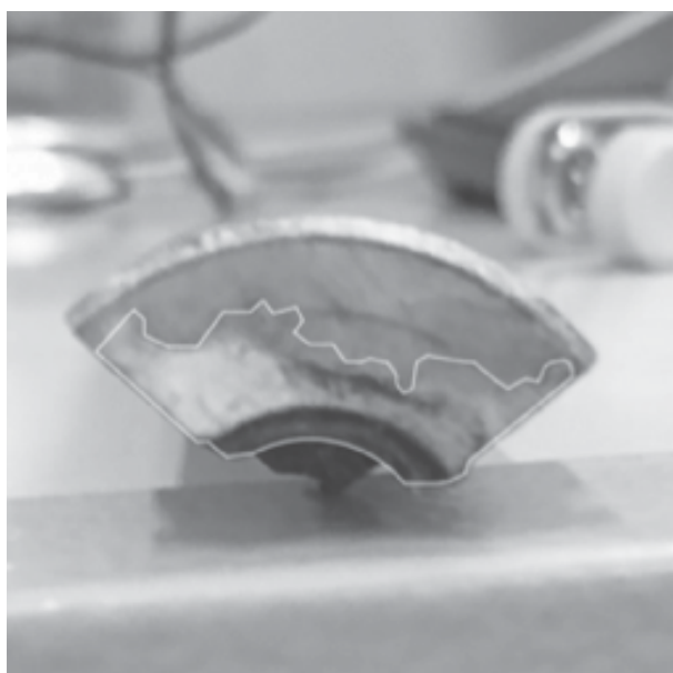
Hình 8: Ăn mòn tại đáy vỏ liều
