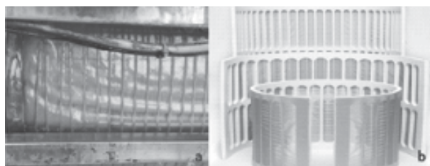
Hình 5. a) Lưới lọc hiện thời, b) Lưới lọc trên thiết bị lọc cải tiến.
