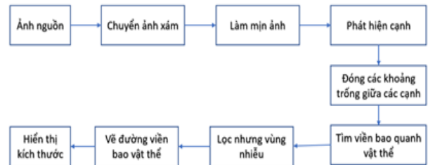
Hình 4. Quá trình xác định kích thước và vị trí của vật.
