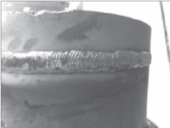
Hình 10. Vết hàn sau khi vận hành mô hình.
