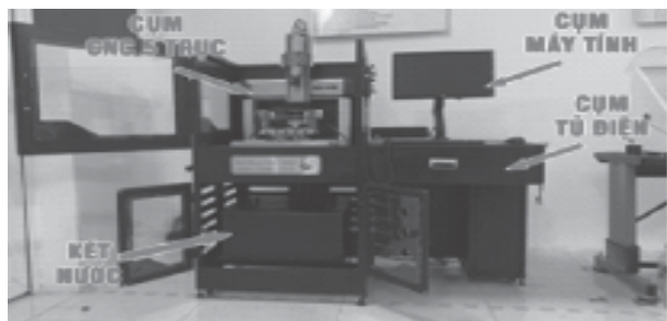
Hình 14. Hình ảnh máy phay CNC 5 trục sau khi thiết kế chế tạo
