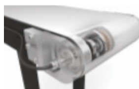
a) Lắp đặt con lăn điện b) Vệ sinh băng tải Hình 3. Lắp đặt con lăn điện thương mại
