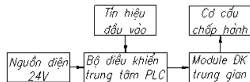
Hình 2. Sơ đồ nguyên lý mạch điện điều khiển trên thiết bị hỗ trợ hàn TIG bán tự động
