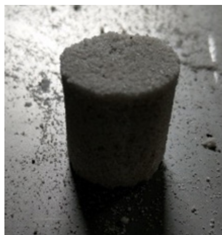
Hình 2. Mẫu khuôn cát - nước thủy tinh thử cơ tính theo tiêu chuẩn AFS
