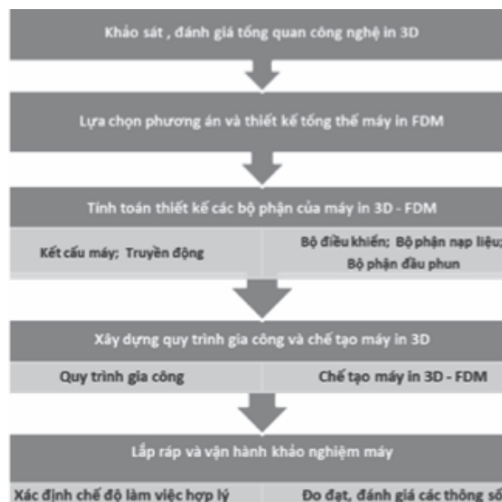
Hình 2. Quy trình thiết kế chế tạo máy in 3D-FDM.
