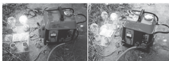
Hình 3. Động cơ chạy bằng khí biogas - Một công trình nghiên cứu của GS. Bùi Văn Ga [1]
