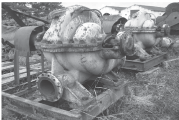
Hình 4. Bơm LT - 1250 m 3 /h tại kho của Công ty Than Mạo Khê - TKV
