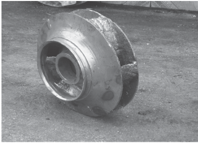
Hình 13. Bánh bơm 160 m³/h (đã mòn hỏng và đang hàn đắp lại)
