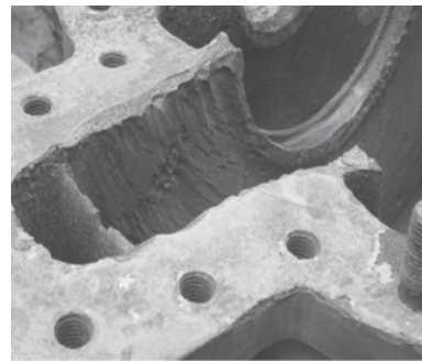
Hình 16. Thân bơm 630 m³/h bị mài mòn tại mỏ
