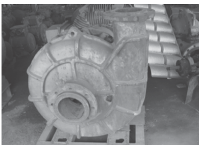
Hình 19. Thân bơm bùn LT8-250 bị thủng tại mỏ than Mạo Khê
