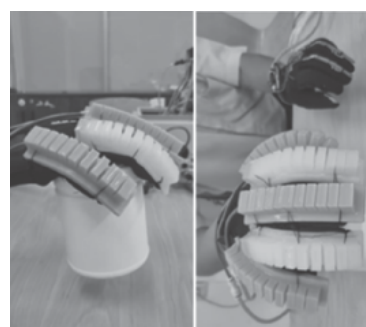
Hình 11. Kết quả thực nghiệm của bàn tay nhân tạo cầm, nắm các đồ vật khác nhau
