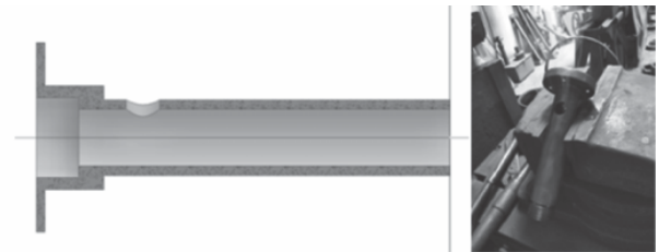
Hình 5. Mặt cắt ngang và quá trình gia công ống dẫn nhựa
