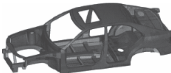
Hình 2. Mô hình phần tử hữu hạn khung vỏ ô tô con sau khi tạo liên kết
