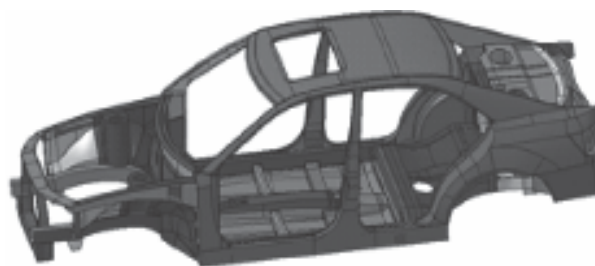
Hình 1. Mô hình CAD khung vỏ ô tô con
