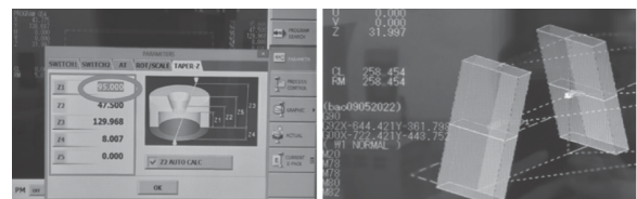
Hình 4. Khai báo chiều cao phôi vào máy và hình mô phỏng hai hố xiên cần gia công
