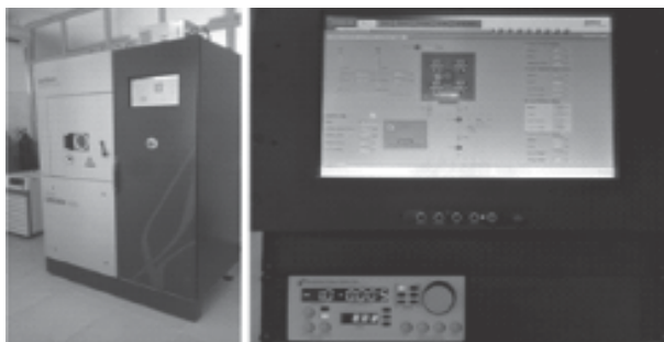
Hình 1. Hệ thống phun xạ Univex 400 phủ cacbon lên nền thép AISI 316L
