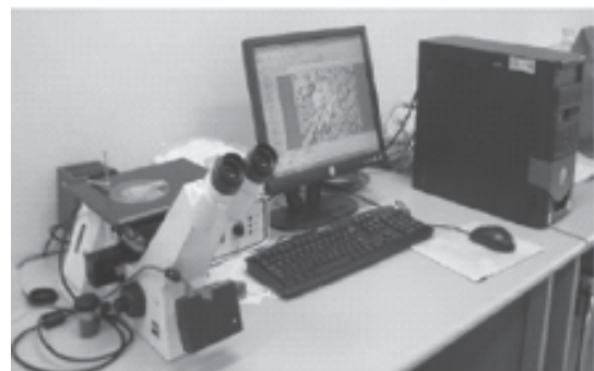
Hình 2. Kính hiển vi quang học Axiovert 25 MAT sử dụng cho thí nghiệm xác định độ xốp lớp phủ plasma.
